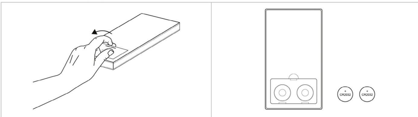
Il modello di batterie da utilizzare è CR2032 3V.
