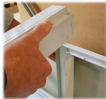
2.2 Posizionare il Silent Compact Box all'interno del Silent Armadio facendolo scorrere sulle sbarre laterali all'interno dell'armadio.
