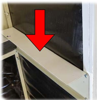
2.3 Utilizzando i bulloni lunghi e rondelle in dotazione fissare il Silent Compact Box al Silent Armadio nella parte ALTA.
