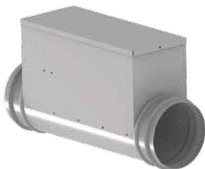
Le unità di pre/post riscaldamento elettriche a sezione circolare sono costituite da telaio in lamiera zincata con resistenza corazzata. Sono predisposte di flange circolari che facilitano l'installazione al condotto. La scatola elettrica laterale già completa di passacavo consente di accedere ai componenti al suo interno:
