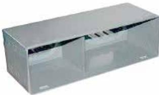
COMBIPL500 è un plenum con mandata e ripresa integrate in un'unica gruppo. È dotato di una separazione ermetica tra lato di mandata e ripresa per evitare corto circuiti d'aria. Una volta installato, è all'occhio un'unica entità. Completo di due collari selezionabili Ø 125 oppure Ø 160 mm (di tipo ovale) posteriori.
