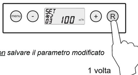
7. Per la modifica dei valori di altri parametri, ripetere le operazioni da 3 a 6. Una volta inserite tutte le modifiche si torna alla modalità normale di funzionamento premendo il tasto 'R'.
