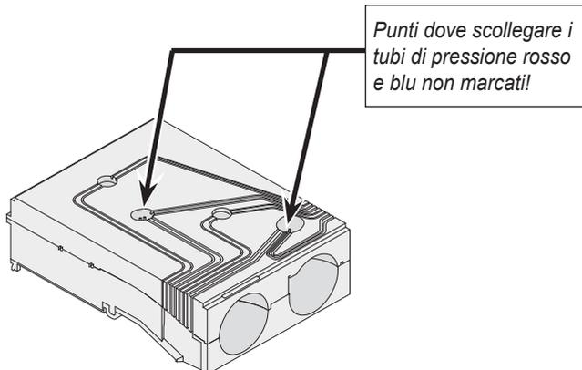
10 Ora è possibile separare le due parti dell'unità per scoprire entrambi i ventilatori; assicurarsi che i ventilatori rimangano appoggiati nella parte inferiore dell'unità!
