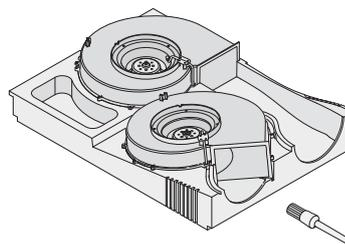
12 Unire le due parti dell'unità di ventilazione e ricollegare i tubi di pressione ai raccordi.
