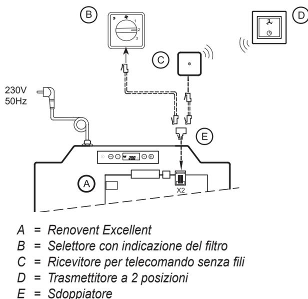
**11.3 Collegamento in rete tramite connessione eBus di più Renovent Excellent; con la stessa portata d'aria**
