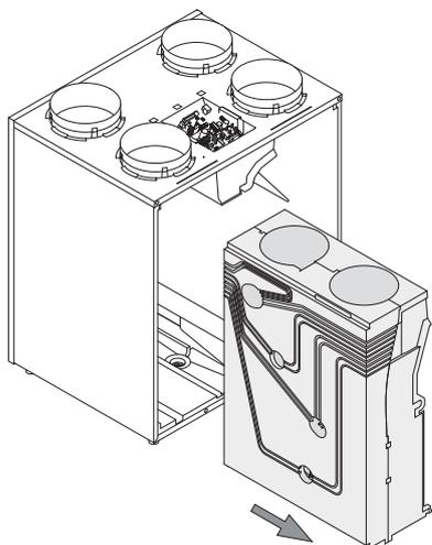
9 Collocare l'unità di ventilazione su una superficie piana, con i tubi di pressione rivolti verso l'alto. Rimuovere dai raccordi montati sull'unità di ventilazione solo i tubi rosso e blu senza marcatura nera. Capovolgere l'unità di modo che i tubi di pressione siano rivolti verso il basso.
