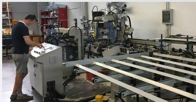
Linea di taglio e foratura a controllo numerico
