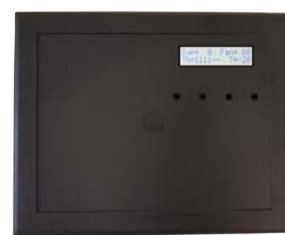
Coperchio scheda elettronica con il display integrato e tasti per il settaggio regolazione 0-10V
