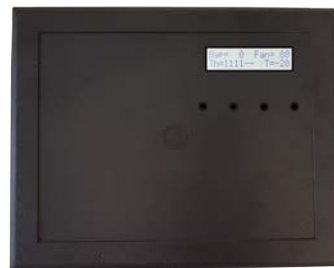
Coperchio scheda elettronica con il display integrato e tasti per il settaggio regolazione
