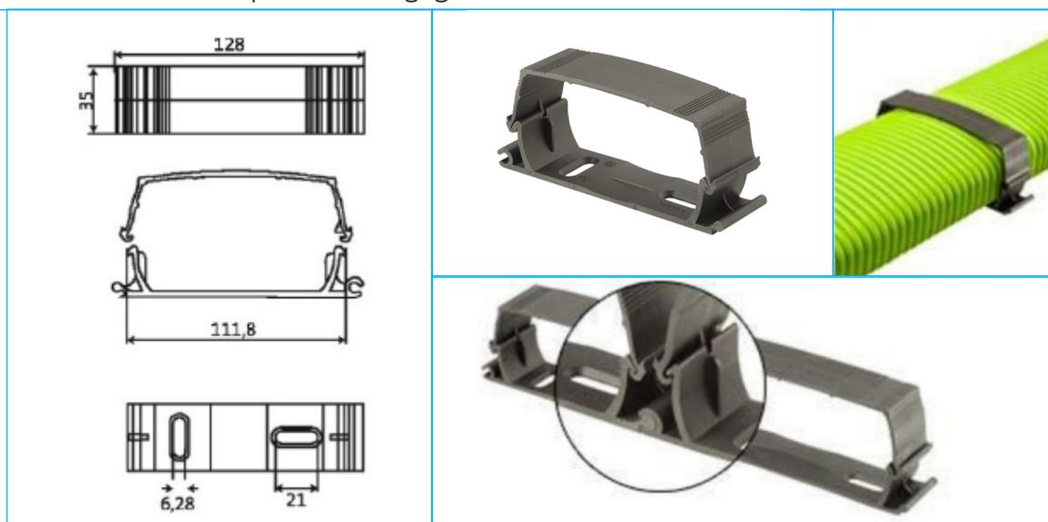
• **Adattatore per valvole Ø125 a due tubi semiovali 50x100 mm cod. VMAVL2250X100**
