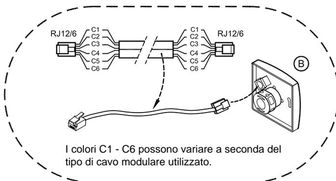
I colori C1 - C6 possono variare a seconda del tipo di cavo modulare utilizzato.
