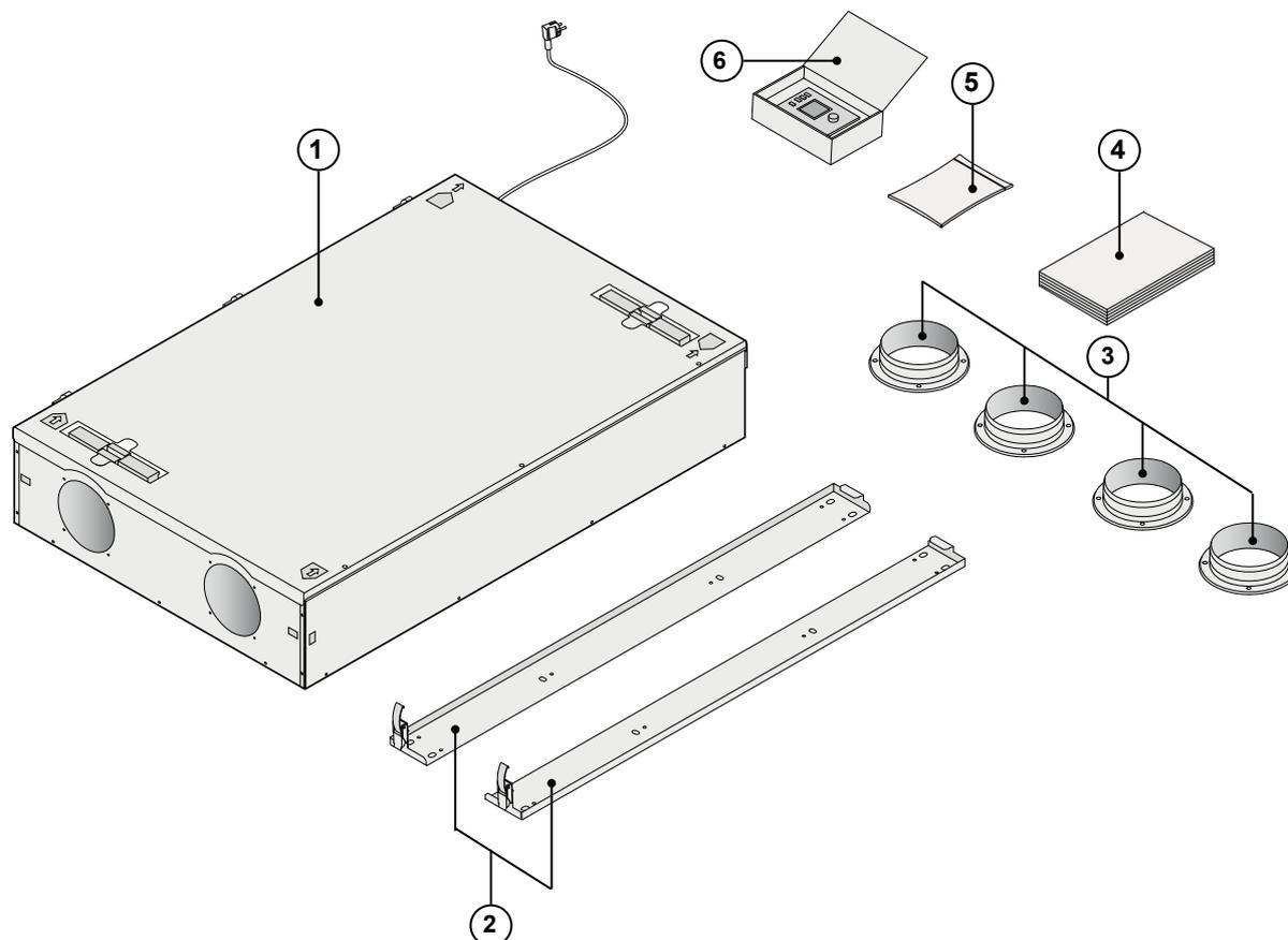
Prima di iniziare l'installazione, controllare che l'apparecchio di ventilazione con recupero di calore sia completo e integro. La fornitura dell'apparecchio di ventilazione con recupero di calore Renovent Sky 150 comprende i seguenti componenti:
