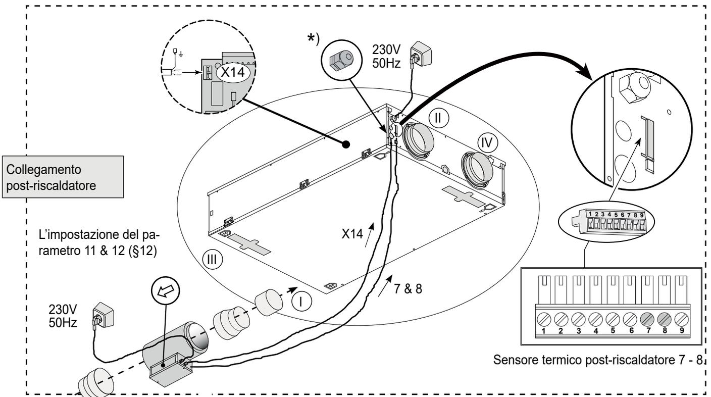
\*) Passacavo da montare a cura dell'installatore (non in dotazione) per il passaggio del cavo 230 volt del post-riscaldatore o del preriscaldatore supplementare.
