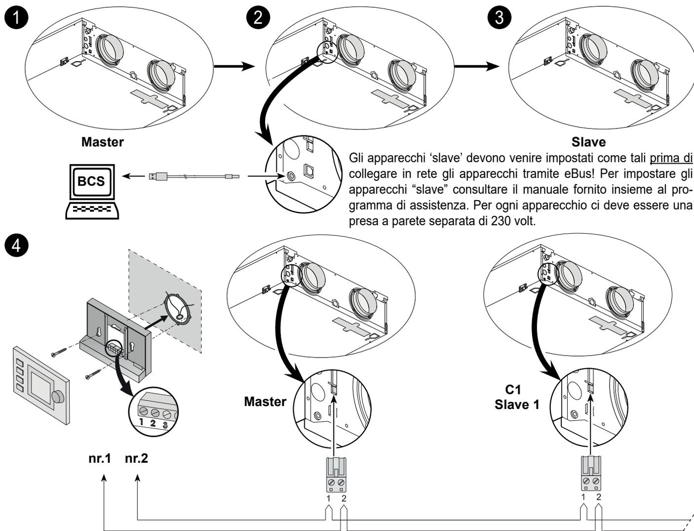
Gli apparecchi 'slave' devono venire impostati come tali prima di collegare in rete gli apparecchi tramite eBus! Per impostare gli apparecchi "slave" consultare il manuale fornito insieme al programma di assistenza. Per ogni apparecchio ci deve essere una presa a parete separata di 230 volt.
