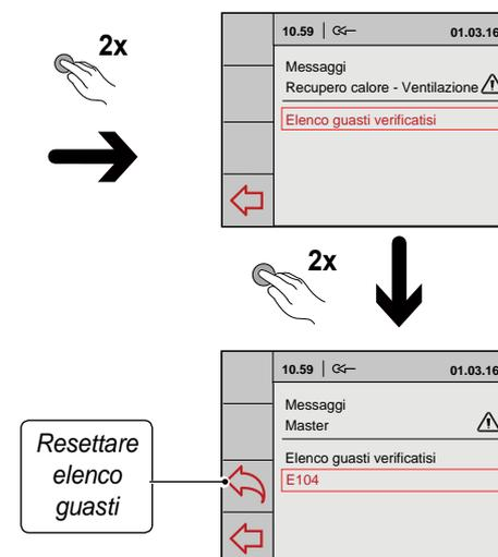
l'apparecchio dalla tensione: occorre prima rimediare al guasto. L'apparecchio rimane in questo stato fino a quando non verrà risolto il problema. Successivamente l'apparecchio effettuerà un ripristino automatico e il display tornerà alla modalità normale di funzionamento.
