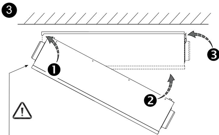
6 Rimozione dell'apparecchio dalle staffe di montaggio.
