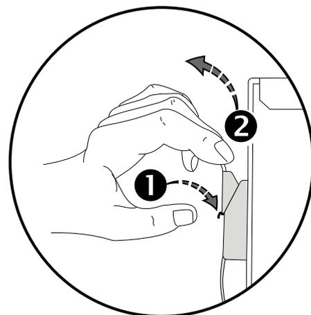
Collegamento dello scarico della condensa.
