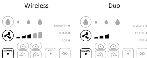
Allo spegnimento dei LED di segnalazione, il pannello remoto entra in modalità ENERGY SAVING. Durante questa funzione, alla pressione di qualsiasi pulsante verrà visualizzato lo stato di funzionamento attuale. Una seconda pressione del pulsante desiderato permetterà di cambiare modalità di funzionamento.
