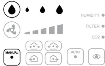
Allo spegnimento dei LED di segnalazione, il pannello remoto entra in modalità ENERGY SAVING. Durante questa funzione, alla pressione di qualsiasi pulsante verrà visualizzato lo stato di funzionamento attuale. Una seconda pressione del pulsante desiderato permetterà di cambiare modalità di funzionamento.
