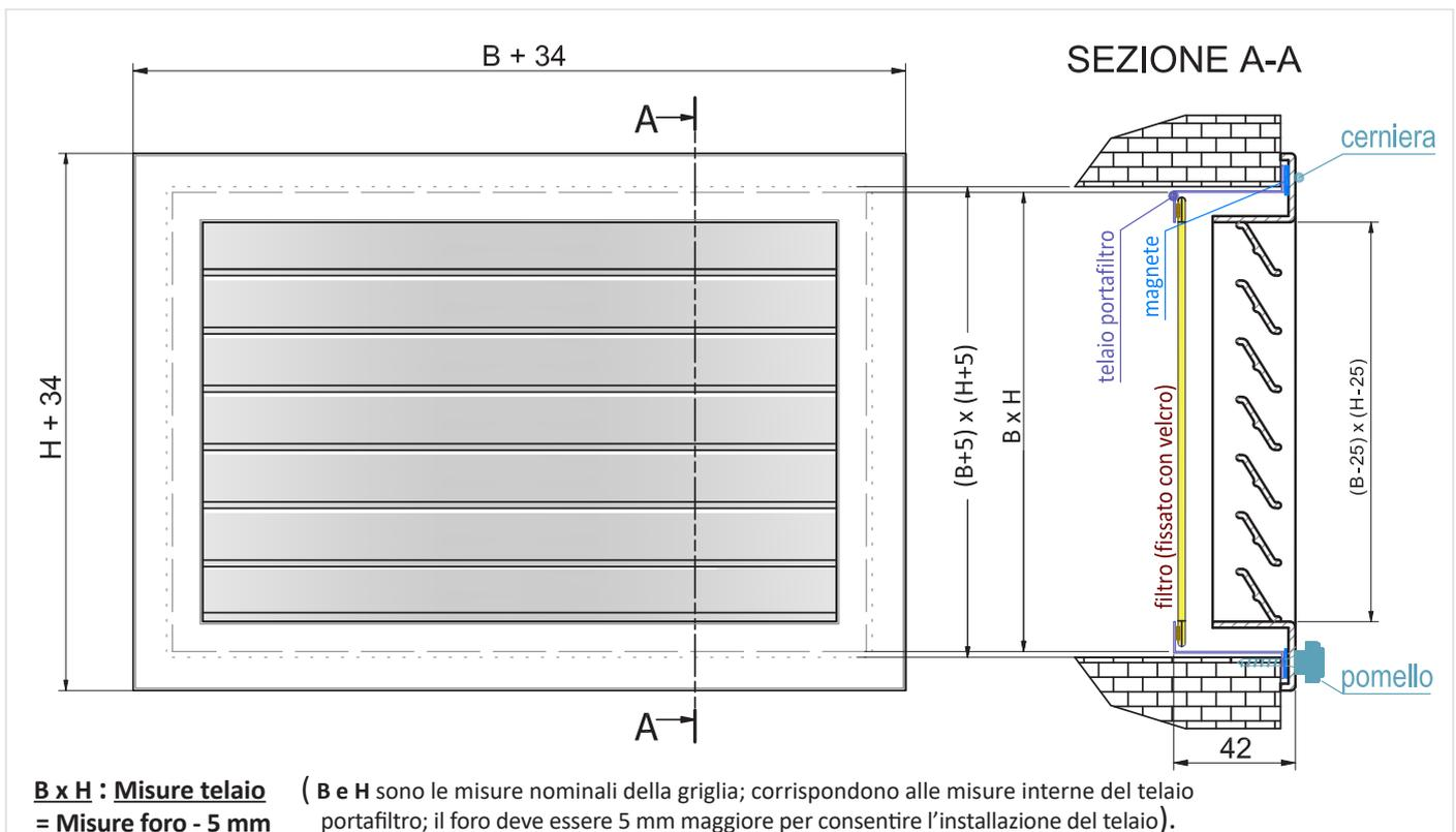
NOTA. Per le altre caratteristiche tecniche, per gli altri particolari dimensionali e per la tabella di dimensionamento rapido della griglie con filtro vedi le Schede tecniche delle rispettive griglie senza filtro (modelli G/01, G/02, G/03, GQ).
