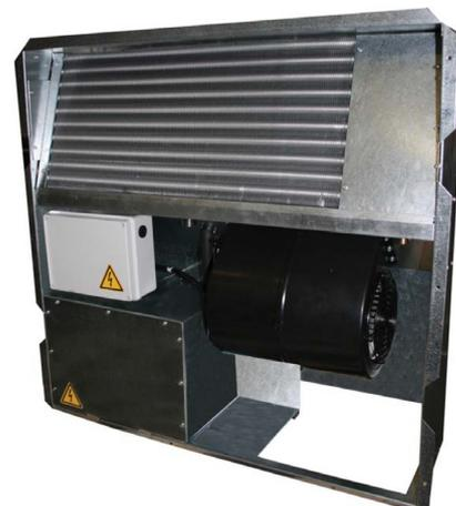
Circuito frigorifero: evaporatore e condensatore a tubi in rame e alette in alluminio passo 2,8mm; compressore di tipo alternativo ermetico, con dispositivi di protezione termica e con coibentazione acustica, montato su antivibranti.
